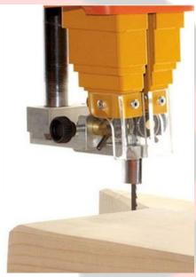
La copiadora es un dispositivo que se aplica a los El sistema de fuelles es un sistema telescópico de cortes con el uso de la plantilla: apoyarse en ella le permite replicar su forma en múltiples piezas con un considerable ahorro de tiempo.
