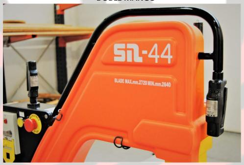
La perilla doble es sinónimo de seguridad: la operación de la máquina solo es posible con el uso de ambas manos en las dos perillas.
